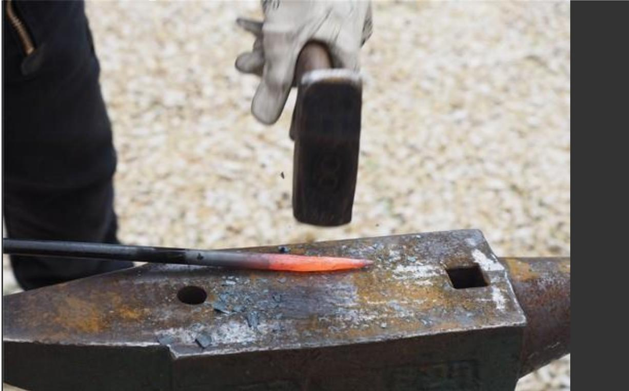
Das glühende Eisen wird mit dem Hammer in Form gebracht.
